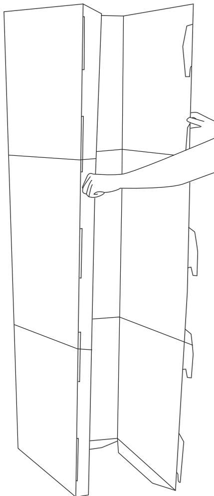
2/ Fermer la colonne à l'aide des cinq pattes que l'on insère dans l'encoche en pincant l'extrémité pliable
